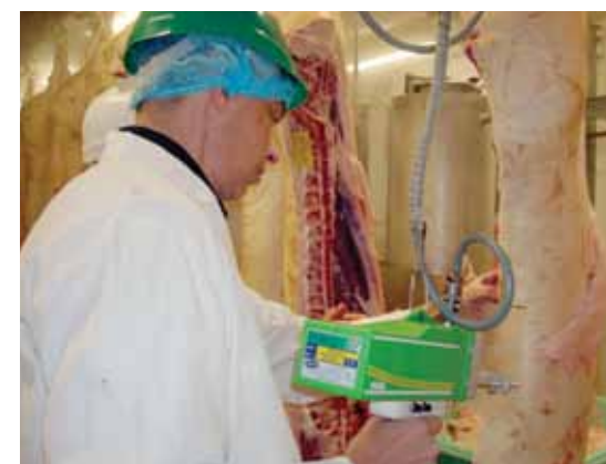
Фото 3. Визначення виходу м'яса за допомогою приладу CGM
