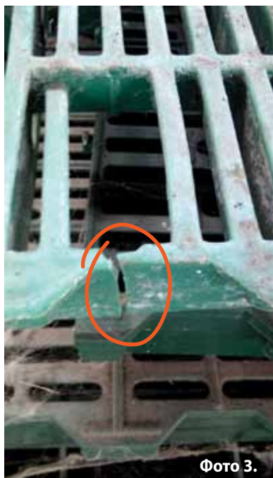
Фото 2–4. Результат експлуатації решіток із неякісної сировини
