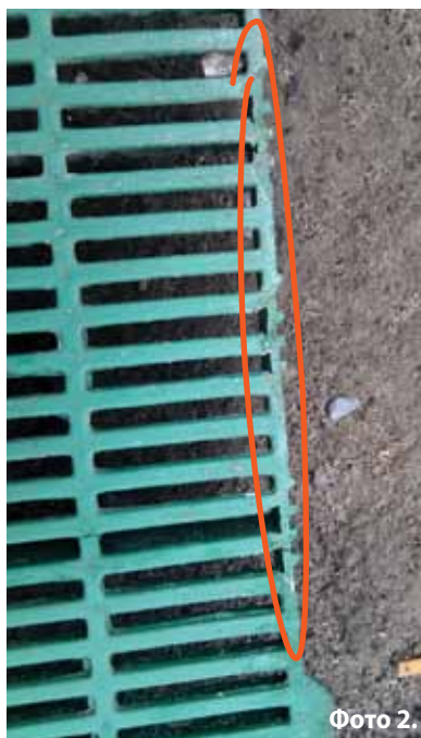
Фото 2–4. Результат експлуатації решіток із неякісної сировини
