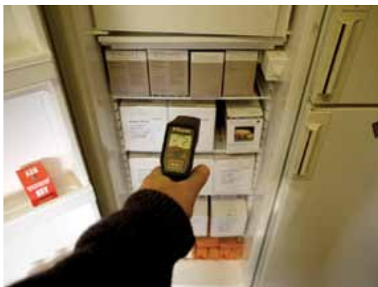
Фото 8. Інфрачервоний пістолет показує мінус 2° С — така температура псує вакцину!
