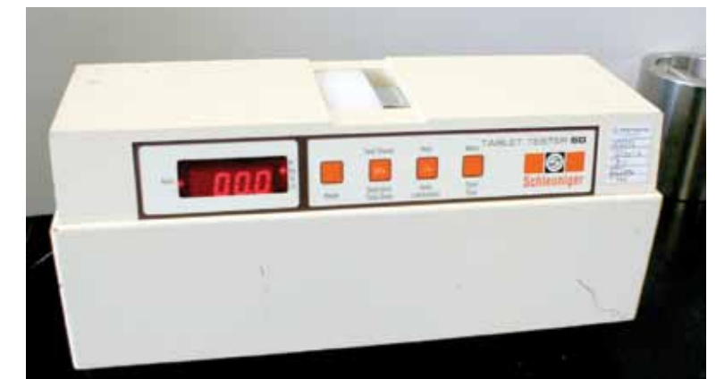
Фото 3. Таблетковий автоматичний тестер міцності гранул Schleuniger
