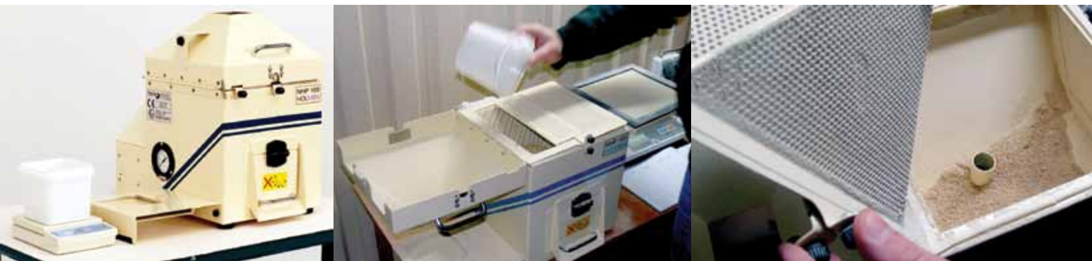
Фото 4-6. Тестер Holmen для перевірки витривалості гранул при пневматичному стресі
