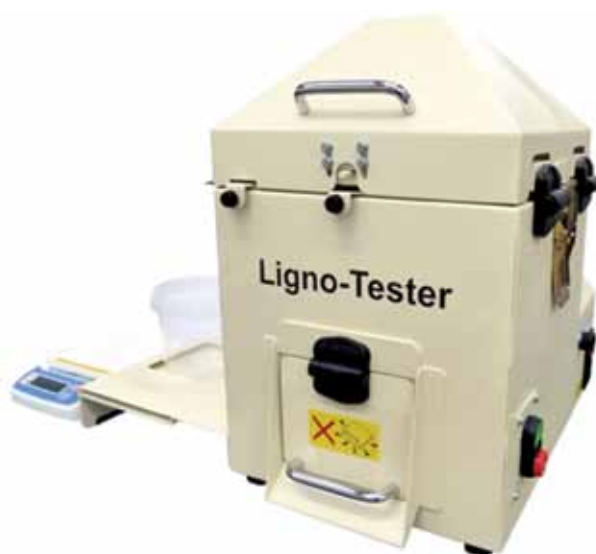
Фото 7. Тестер Ligno, що перевіряє міцність гранул за умов механічного та пневматичного стресів
